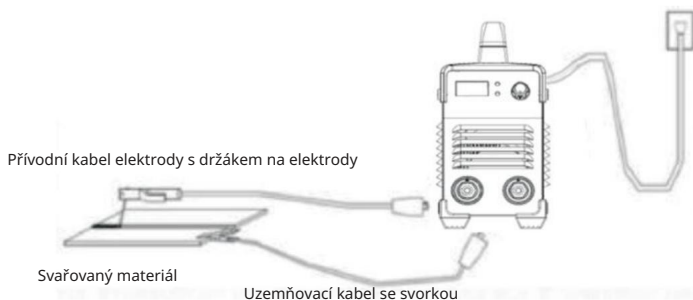
Obrázek č. | 2: Zapálení svařovacího oblouku během ručního obloukového svařování
